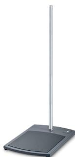
**28. SOPORTE UNIVERSAL:** Material utilizado en el laboratorio como sostén de diversos sistemas sobre el mesón. Consta de un pie horizontal y un vástago fijo en él verticalmente.
