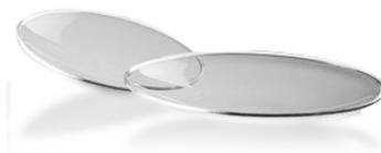
**22. VIDRIO RELOJ:** Platillo cóncavo utilizado para impedir que se produzcan salpicaduras cuando se calienta una solución en un vaso de precipitado. Sirven para evaporar en ellos pequeñas cantidades de líquidos. Se utiliza además para realizar masada. Se encuentran en colecciones de distinto tamaño.
