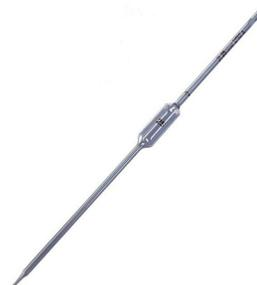
**14. PIPETAS:** Tubos cilíndricos graduados, existen dos variedades y de varias medidas:
