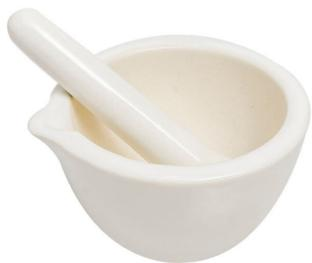
**18. MORTERO:** Recipiente de poca altura destinado a pulverizar toda clase de sustancia. Su interior está sin barnizar a fin de triturar los cuerpos que se someten a su acción, mediante un mango o pistilo.
