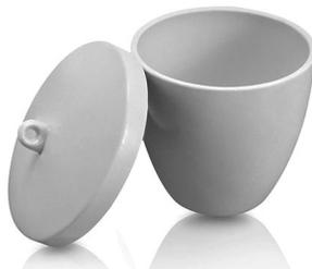
**16. CRISOL:** Recipiente en el cual se someten algunos cuerpos a elevadas temperaturas, los más usados son los de porcelana, los cuales poseen una tapa con asa. Existen, además, crisoles de Cu, Ni, Pt, Fe, etc. Crisol Gooch: Crisol de porcelana o vidrio que posee el fondo perforado con o sin una placa también perforada y se emplea tanto para calcinar como para filtrar al vacío a través de una placa de asbesto como medio filtrante, colocada entre el fondo y la placa cribada.
