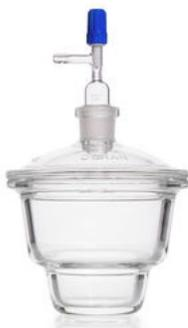
**1. DESECADORA:** Aparato que consta de un recipiente cerrado que contiene una sustancia deshidratante, quedando el aire interior totalmente seco. Sirve para dejar enfriar en atmósfera seca, precipitados calcinados o simplemente calentados a temperatura próxima a los 1000 oC, estos precipitados al enfriarse tienen tendencia a absorber humedad, si la atmósfera que los envuelve es húmeda.
