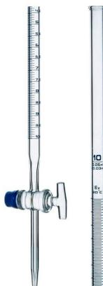
**11. BURETA:** Tubo de vidrio graduado y de calibre uniforme, que sirve para medir volúmenes de líquidos con mayor precisión. Tiene la parte superior abierta, por donde se llena con ayuda de un embudo simple; y el extremo inferior termina en una llave. Se las clasifica en dos grupos:
