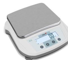
**35. BALANZAS:** Son instrumentos destinados a determinar la masa relativa de los cuerpos (con respecto a una masa patrón). Existe diversos tipos de balanzas y las más comunes en un laboratorio de química son la llamadas granataria y analítica. La balanza granataria, con precisión de masada hasta 0,01 g; y balanza analítica, con precisión de masada hasta 0,0001 g. Cabe hacer notar que las balanzas, cuanto más exacta son, menor es su capacidad máxima.
