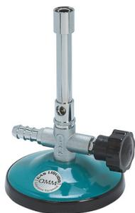
**33. MECHERO:** El mechero Bunsen es el más simple: consta de un tubo de hierro inserto en una base metálica. En la parte inferior existe una entrada regulable del aire y un tubo lateral que conecta con la manguera proveniente de la fuente de gas.
