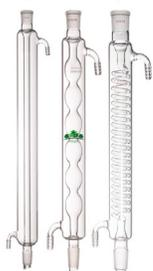
**21. REFRIGERANTES O CONDENSADORES:** Sirven para poner en contacto los vapores de un líquido con paredes enfriadas por una corriente de agua externa para condensarlos. Por la forma de la tubuladura central se conocen los siguientes tipos de refrigerantes:
