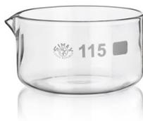
**34. CRISTALIZADORA:** Recipiente cilíndrico de vidrio de poca altura y base ancha, con pico o sin él. Sirven para obtener sólidos cristalinos.
