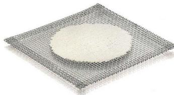
**31. REJILLA DE ASBESTO O DE AMIANTO:** Rejilla metálica con disco de asbesto central, se pone entre la llama del mechero y el recipiente que contiene la sustancia a calentar, para que la acción del calor no sea muy directa.
