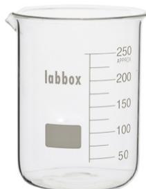
**2. VASO DE PRECIPITADOS:** Recipiente de forma cilíndrica, alargado o achatado, con o sin graduación. Los hay de diferentes capacidades. Se utiliza para contener y calentar líquidos, en la obtención de precipitados y en la preparación de soluciones
