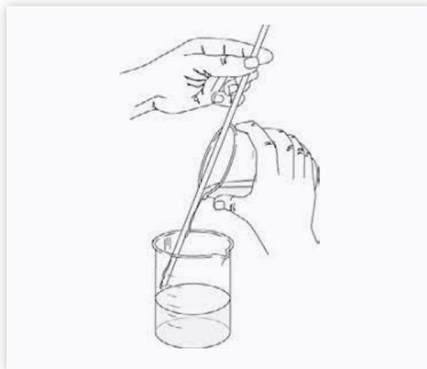
**FIGURA 5.** *Uso de una varilla de vidrio para evitar salpicaduras cuando se vierte un líquido de un recipiente a otro.*
