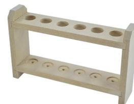
**29. GRADILLA:** Soporte para tubos de ensayos. Las hay de madera y metálica.
