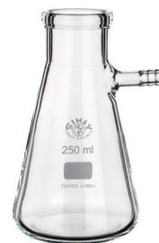
**6. MATRAZ DE KITASATO:** Matraz resistente, empleado en filtración al vacío como recipiente receptor del filtrado. Posee en el cuello una tubuladura lateral que se conecta a la trompa o bomba de vacío.
