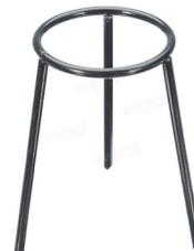
**26. TRÍPODE:** Anillo metálico sostenido en tres pies del mismo material. Sirve para sostener la rejilla de asbesto.
