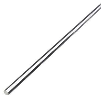
**12. VARILLA DE AGITACIÓN:** Varilla de vidrio de largo apropiado y cuyos extremos se redondean a la llama de un mechero. Sirven para agitar soluciones (disolver el soluto), trasvasar líquidos o soluciones y filtrados al embudo.
