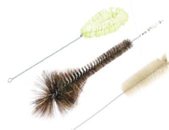
**32. HISOPOS:** Escobillas de cerda utilizada para limpiar los tubos de ensayos, matraces, etc.
