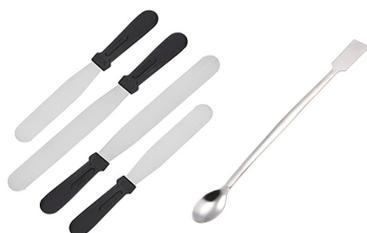
**27. ESPÁTULA:** Lámina metálica con un mango de madera, se emplea para trasvasar sólidos. Las hay de distintas formas y material (otro ejemplo es la cucharilla).
