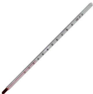
**13. TERMÓMETRO:** Instrumento necesario en procesos químicos y térmicos. En destilación se utiliza para reconocer los puntos de ebullición de los líquidos a destilar. Empleado también para determinar puntos de fusión, etc.
