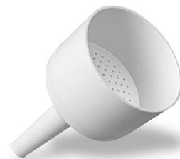
**17. EMBUDO BUCHNER:** Recipiente de porcelana, de forma cónica, todo de una pieza, con una placa central en forma de criba (perforada) sobre la cual se coloca el papel filtro recortado y humedecido. Se utiliza en filtración al vacío apoyado sobre un matraz de Kitasato.
