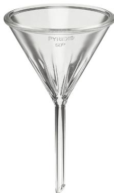
**10. EMBUDO ANALÍTICO:** Recipiente de vidrio o porcelana, de forma cónica, abierto por la base y terminado en un vástago por donde escurre el líquido. El extremo del vástago va cortado en bisel, lo que permite una mejor caída del líquido. En el embudo corriente la superficie interna es lisa, pero también los hay de paredes internas rizadas con las cuales se logra una filtración más rápida.
