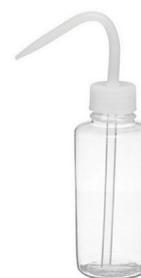
**23. PISETA O FRASCO LAVADOR:** Recipiente plástico para contener líquidos de lavado, tienen un tubo de salida del líquido que permite que salga un chorro fino.
